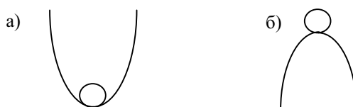
Рис. 3.1. Системы «поверхность – шар»: а – устойчивая; б – неустойчивая.
