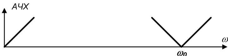
Рис. 6.22. АЧХ идеальных дифференцирующих элементов постоянного и переменного токов
